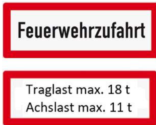
Bild 6 — Beispiel für ein Hinweisschild mit Abweichungen von den Anforderungen dieses Dokuments an die Traglast und die Achslast (hier erhöhte Traglast 18 t und Achslast max. 11 t möglich)
